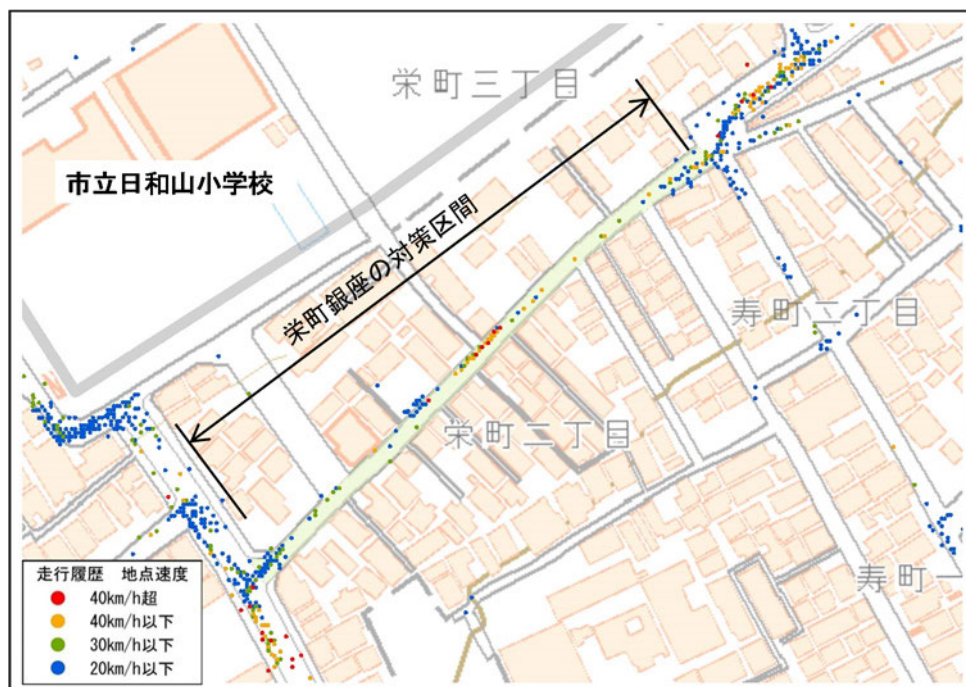
図 2-5 ETC2.0 による走行トリップの走行速度（国土交通省新潟国道事務所提供）
