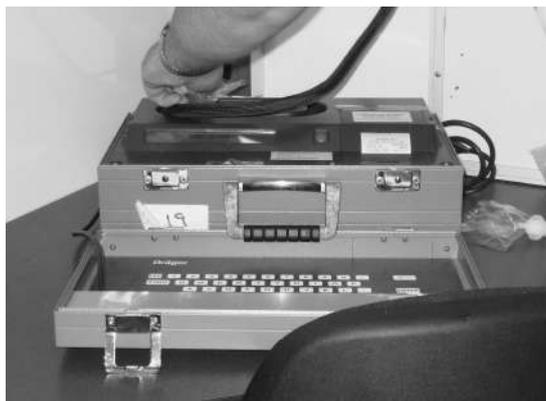
写真2-2-10 Booze Bus 内の定量性に優れた呼気中アルコール濃度測定器
