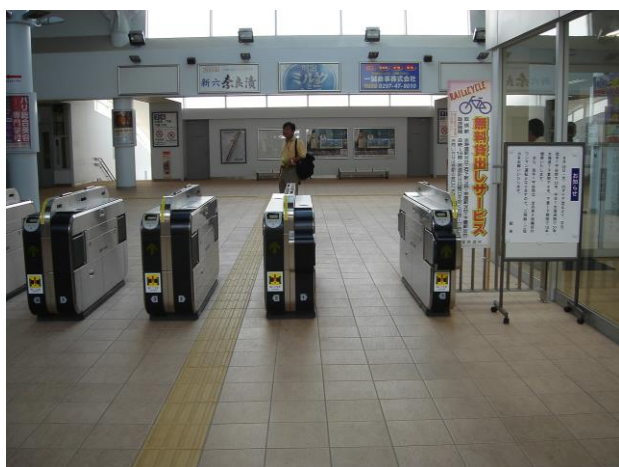
16-1 車いす使用者が利用できる幅の広い改札と点字ブロックを設置した改札を分けているケースである。このような設置が望ましい。（つくばエクスプレス線守谷駅）
