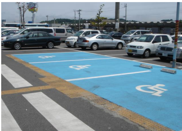
17-1 このケースのように障害者用駐車スペースに点字ブロックを広く設置することで、車いす使用者はバリアと感じる。(福島県いわき市)
