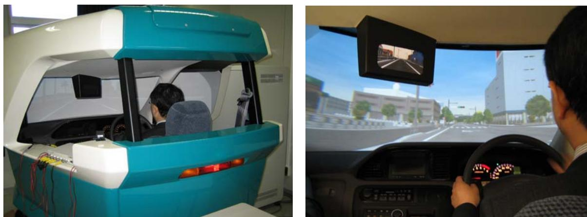
Fig.2-2 本研究で用いた DS(ホンダ社製ドライビングシミュレータ)
