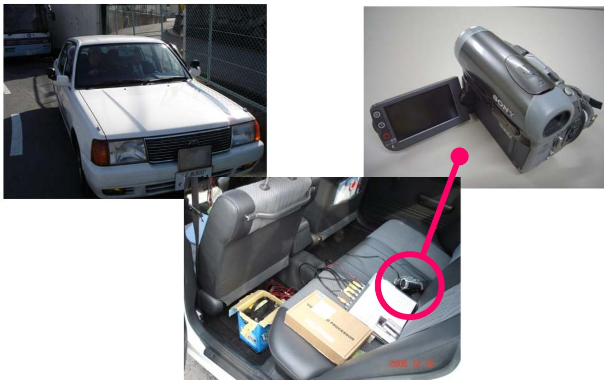
Fig.2-10 使用した教習車両(左上)・車内の実験機材(中央下)・映像記録用のDVカメラ(右上)
