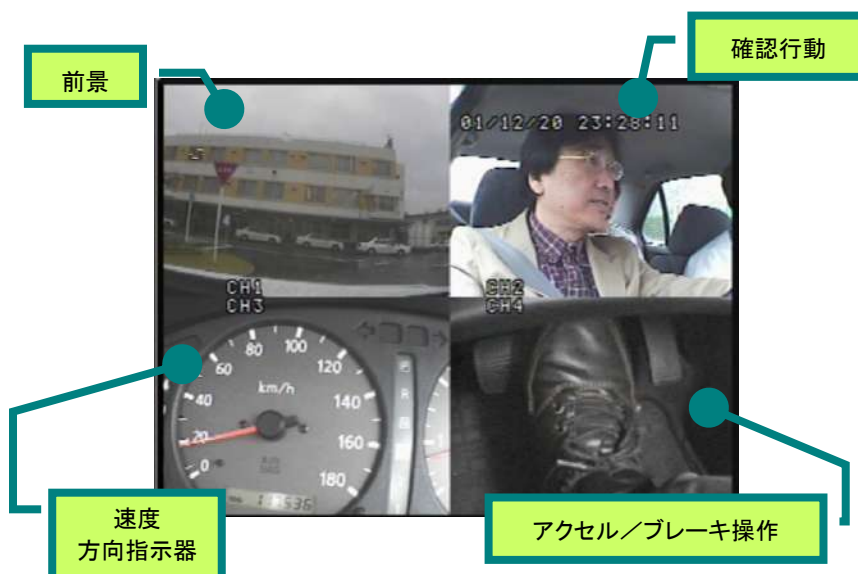
図 2-2 4 台の小型カメラで合成された走行中の映像
