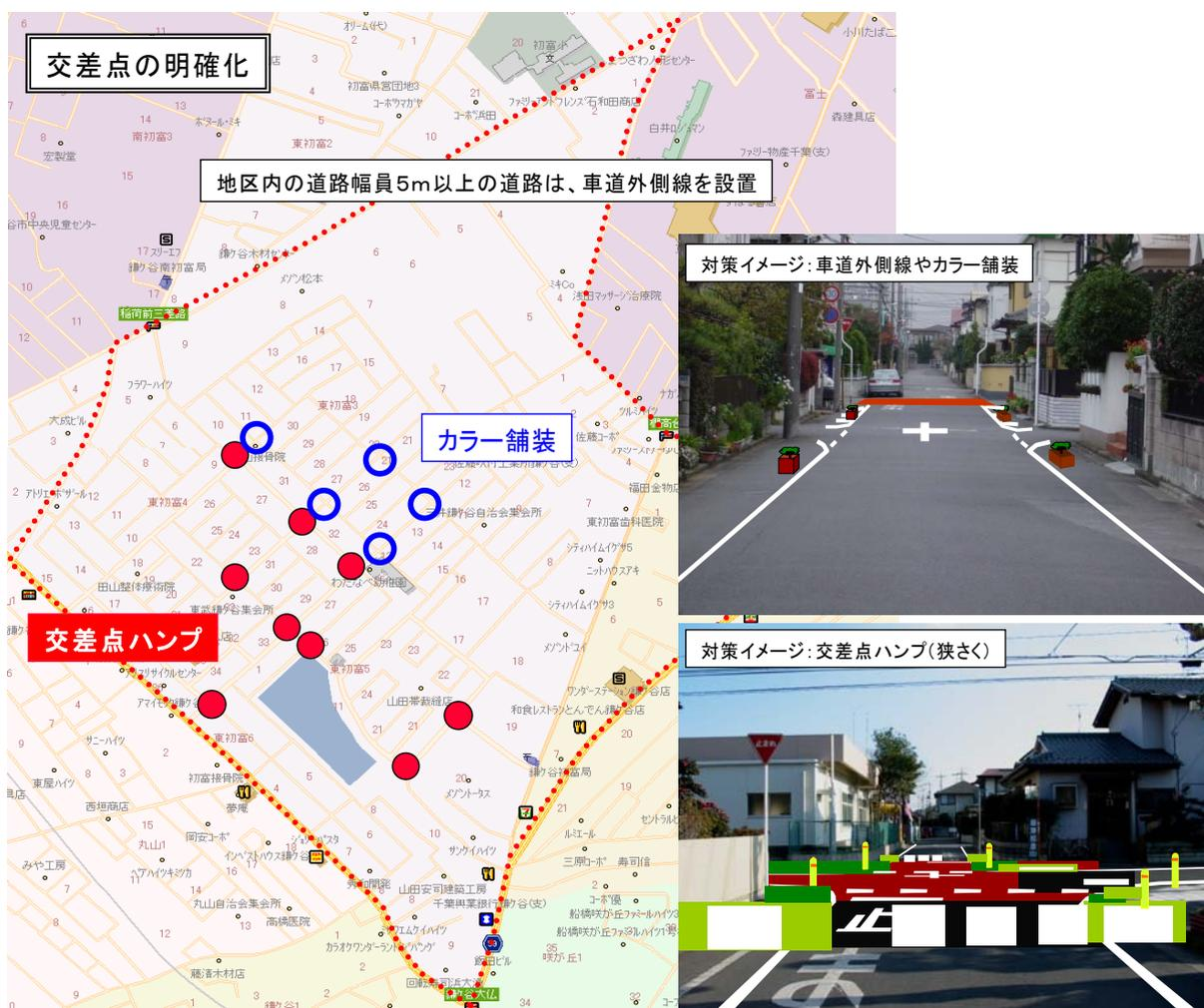
図 5-5-1 交差点ハンブおよび交差点カラー舗装の施工箇所と対策イメージ
