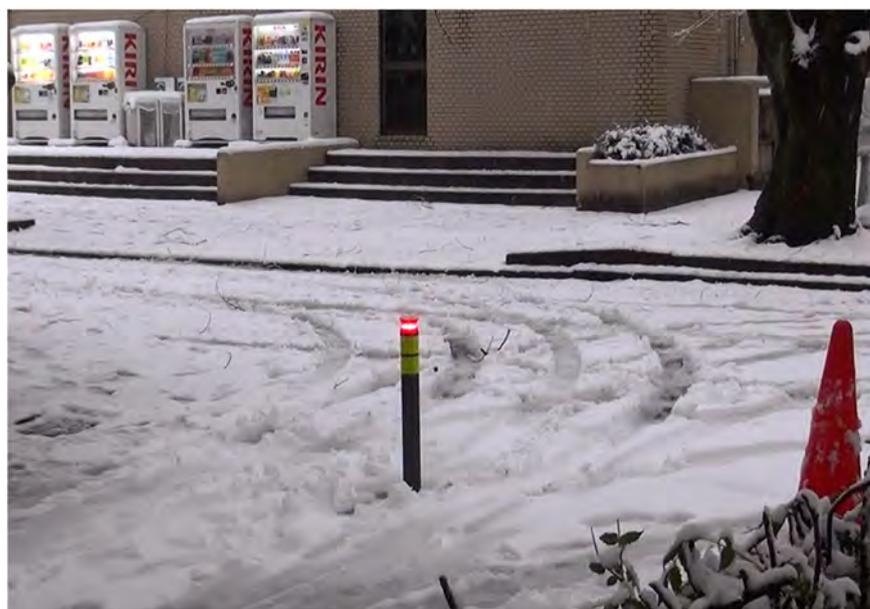
図 2-18 降雪時にボラードが作動している様子
