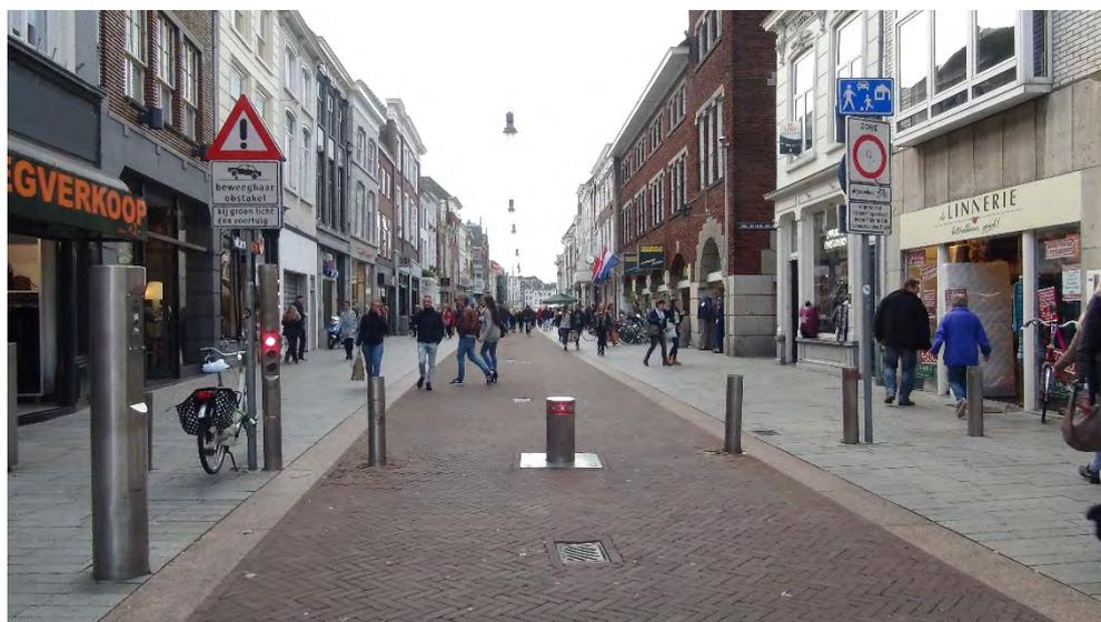
図 2-1 海外で利用されているライジングボラードの例（オランダ，セルトーヘンボス）
