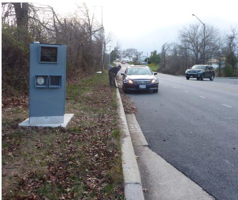
図 3-8 据え置き型 (可動式) の自動速度計測器
