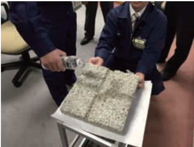
写真 3.6 シラスを原材料として使用した保水性の高いブロック（2015年2月10日撮影）
