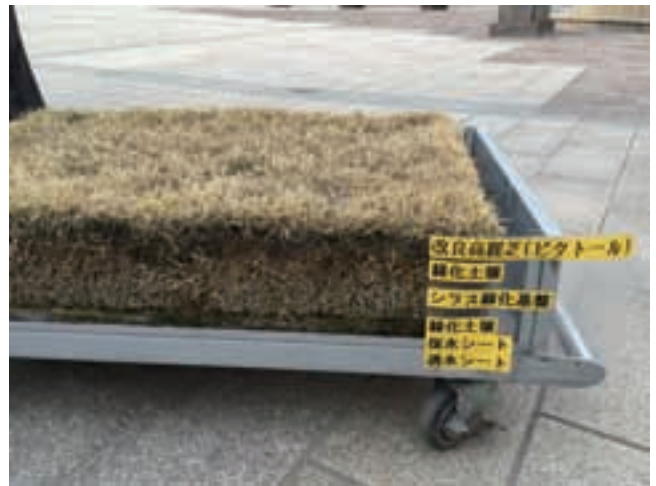
写真 3.7 軌道敷緑化の断面構造（2015年2月10日撮影）
