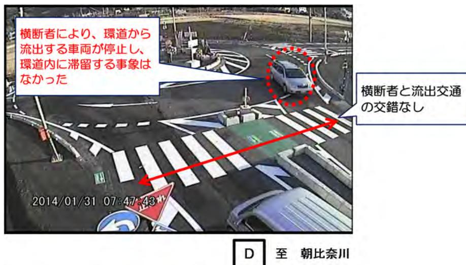
図-C4.8.8 横断歩道位置による走行車両への影響
