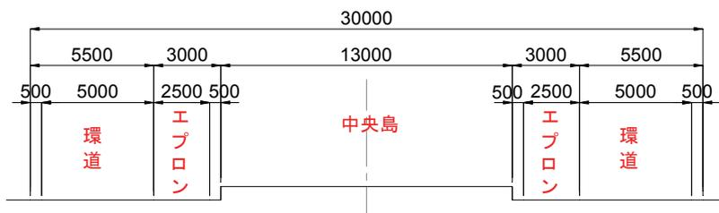
図-C2.3.4 東和町ラウンドアバウトの環状部断面図
