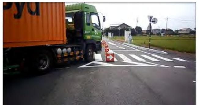
写真-C4.8.1 セミトレーラの走行確認
