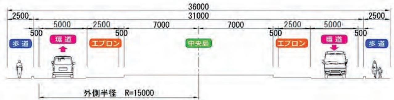
図-C6.3.4 ラウンドアバウトの横断構成
