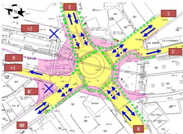
a) Step.1 交差点外側の施工
