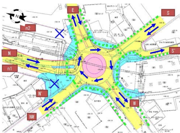
c) Step.3 中央部の施工
