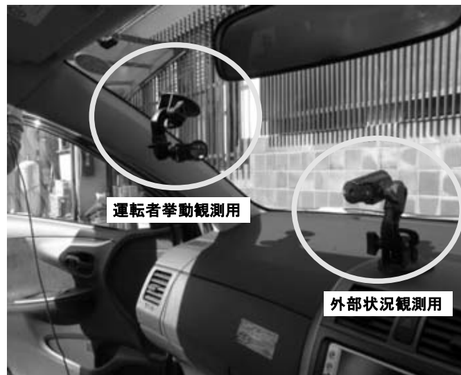
図-3.14 ビデオカメラ設置状況
