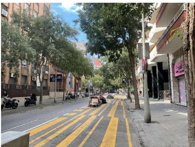
Fig. 6 仮設工作物による車線減少、自転車レーン設定と歩行空間拡張の例
