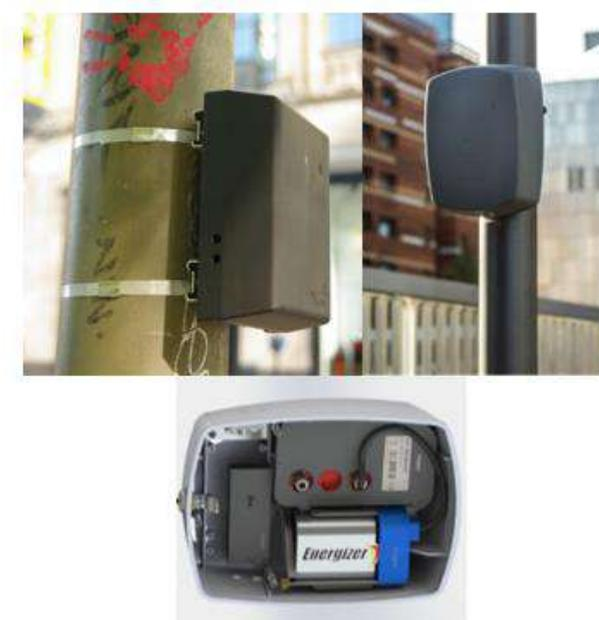
Fig. 1 PYRO-Box の外観及び内面構造
