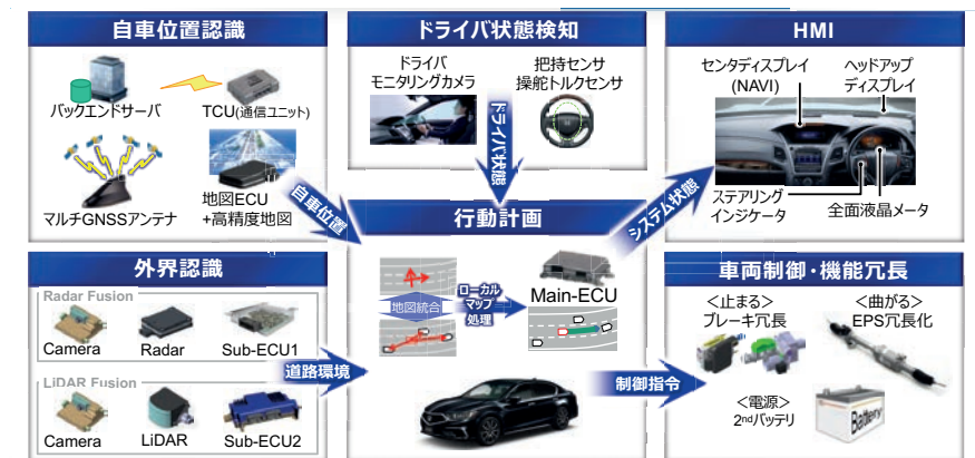
図 8.13 自動運転（レベル 3）システムの構成。
