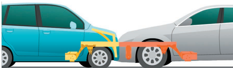
図 7.10 コンパチビリティ対応ボディー模式図（本田技研工業提供） [14] 。
