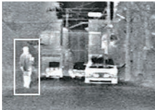
図 7.9 インテリジェント・ナイトビジョンシステムによる歩行者強調表示の例（本田技研工業提供） [12] 。
