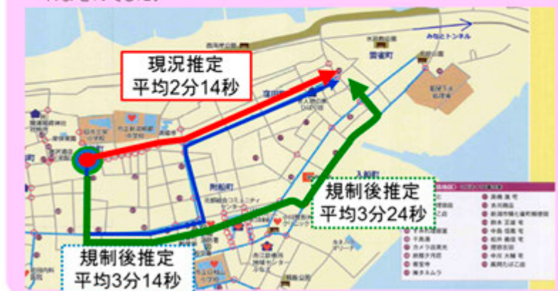
図 1-12 交通シミュレーションを実施して通行規制後の所要時間を紹介した例
