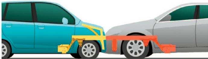
図3 コンパチビリティ対応ボディー模式図<sup>2)</sup>
