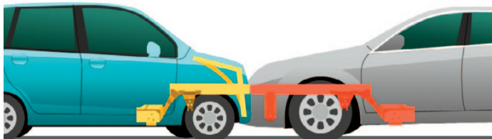
図3 コンパチビリティ対応ボディー模式図 2)
