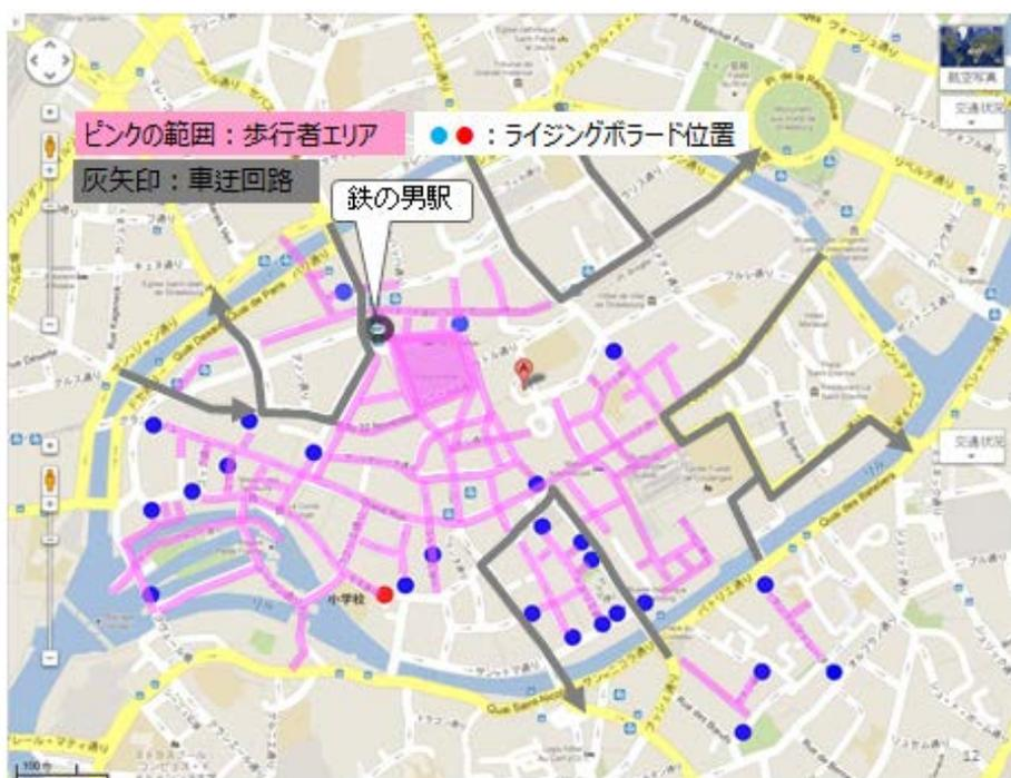
図 2-2 ストラスブール市ライジングボラード位置図
