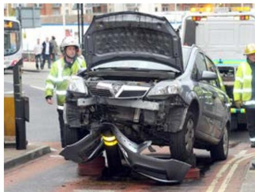
写真 3-1 ハードライジングボラードの衝突事故の様子(ノースヨークシャー、英)<sup>1</sup>
