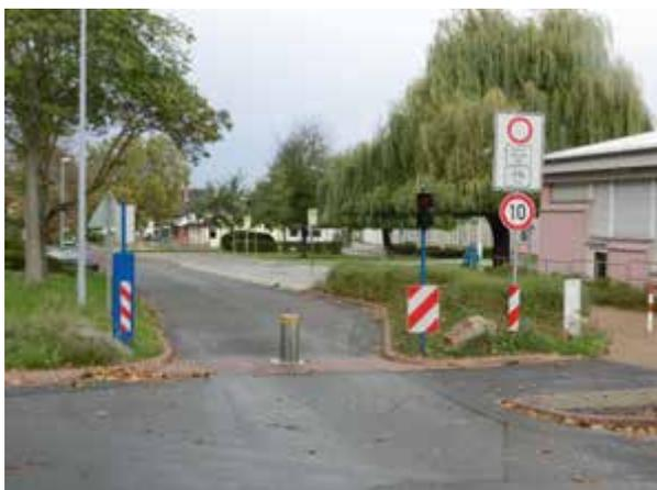
写真 2-6 バートクロイツナッハ市のライジングボラード
