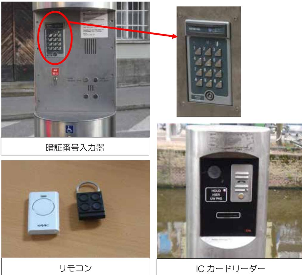
写真 2-2 下降操作システムの例
