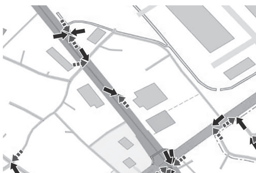
Fig. 9 交通事故データの方位角と緯度経度情報を地図上に表示した例 (←:自動車、- - ←:自転車)
