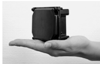
Fig. 7 ミリ波レーダーの一例: 車載用小型77GHz 3次元電子スキャンミリ波レーダー(富士通テン)
