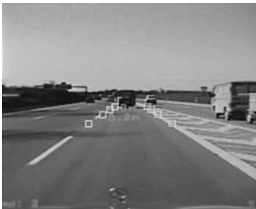
Fig. 2 VaMPのマシンビジョンが検出した道路シーン（レーンマーカーと先行車を検出している）(Dickmanns教授提供のビデオから)
