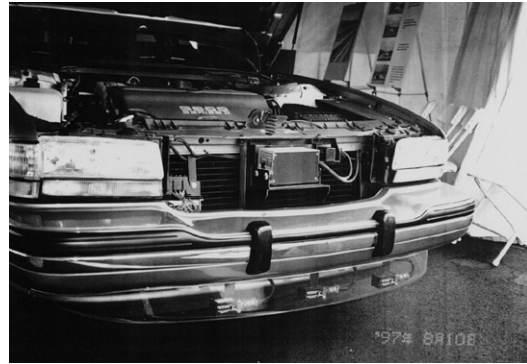
Fig. 3 2種の磁気マーカー(左は通常型、右は強力型)(左)と前バンパー下に装着された3個の磁気センサー(右)
