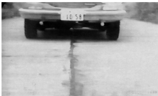
Fig. 1 路面下に埋設された誘導ケーブルとバンパー両端近くに装着された一対のピックアップコイル
