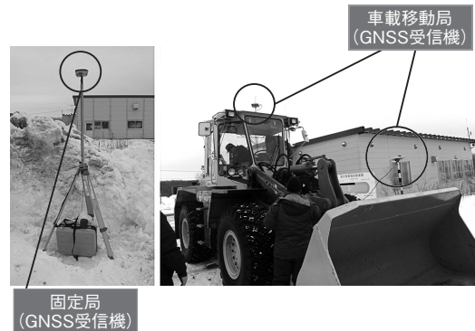
Fig. 5 RTK-GNSS設置状況
