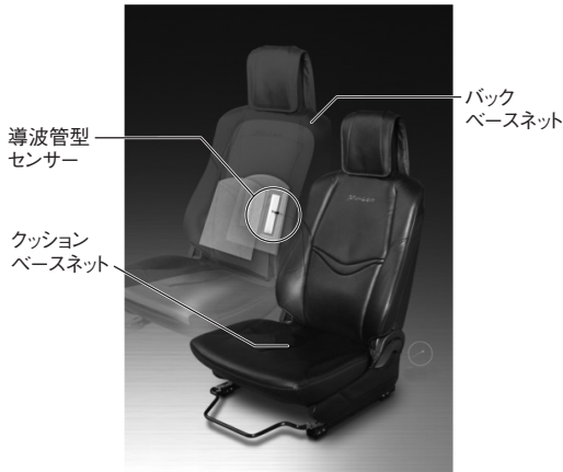
Fig. 2 着座センサーシート
