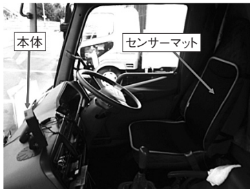
Fig. 9 システムのトラックへの装着状態
