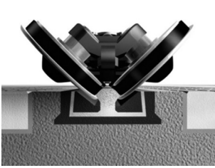
Fig. 1 トランスロールのガイド構造
