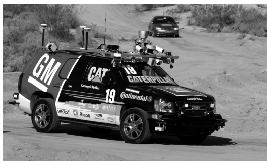
Fig. 6 自律自動走行試験車両 (DARPA Urban Challenge 2007優勝車)
