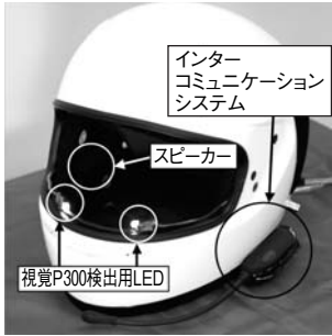
Fig. 7 インターコミュニケーションシステムを設置した実験用ヘルメット
