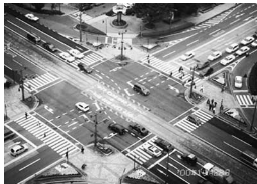
Fig. 4 交差点軌道敷内停止禁止ゾーン設置状況
