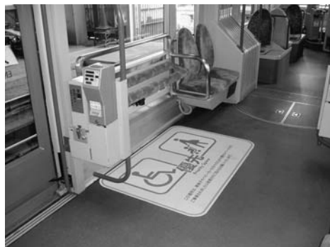
Fig. 12 車いす・ベビーカースペース
