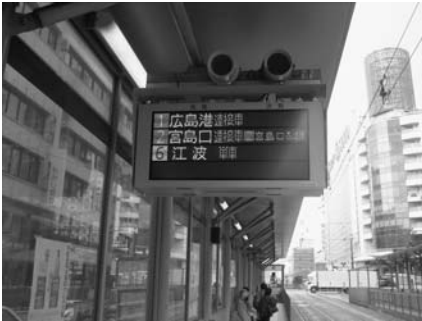
Fig. 21 高度化された電車接近案内表示器
