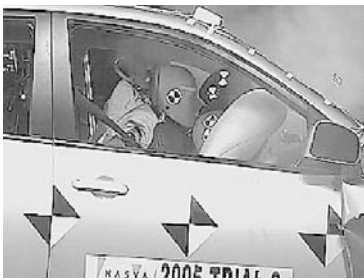
Fig. 5 123msにおける女性ダミーの挙動
