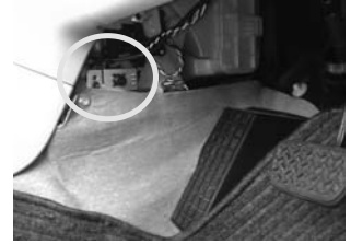
Fig. 8 ドライバー足元撮影用カメラ
