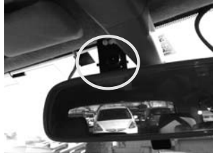
Fig. 7 ドライバー顔面撮影用カメラ
