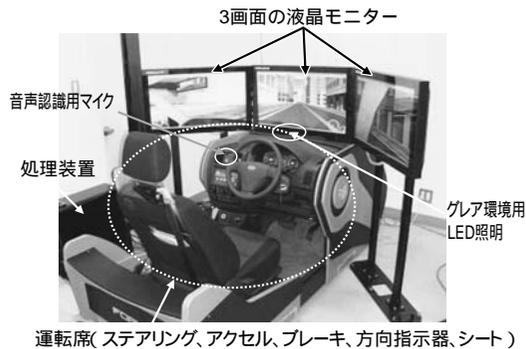
Fig. 3 運転機能測定シミュレータの構成
