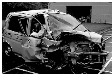
小型車と大型車の衝突においてお互いのメインフレームがすれ違った時の小型車は、変形量、乗員傷害値が増加する Fig.6 お互いのメインフレームのすれ違い
