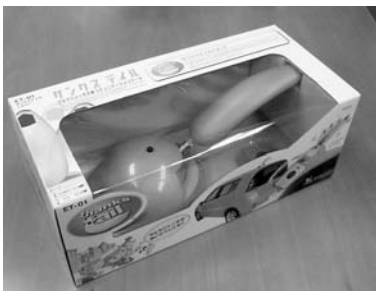
Fig. 11 小ヒットに終わった製品版。1軸制御で、電池駆動だったのが反省点として挙げられる
