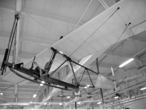
Fig. 1 初級滑空機・霧ヶ峰式ハトK14型（滝川スカイパーク所蔵）
