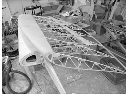
Fig. 4 製作中の1号機M 01の外翼構造体。木材とFRPコンポジット材できている
