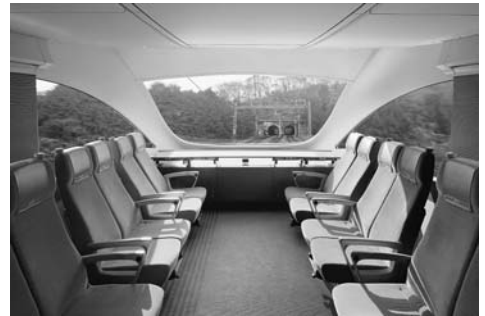
資料提供) 小田急電鉄株式会社。 P.37グラフィア参照。 Fig. 12 展望席が90度回転し、ラウンジ形式となる
