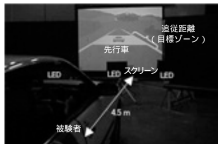
Fig. 1 簡易シミュレータによる先行車追従課題
