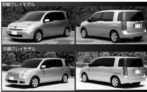
Fig. 7 上段：初期クレイモデル、下段：中期クレイモデル
