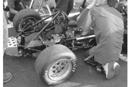
ペダル類がフロントアクスルより前方に位置する Fig. 5 上智大学の車両
