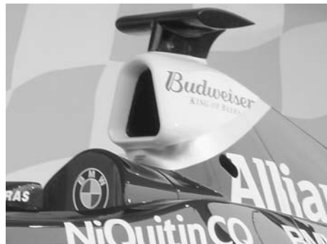
Fig. 3 2003年型ウィリアムズF1のロールバー
