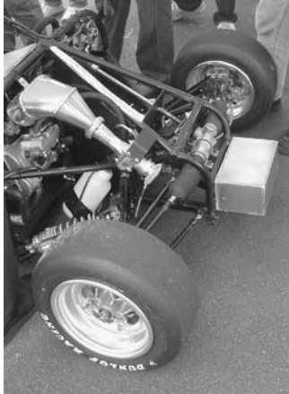
Fig. 4 衝撃吸収ボックス
