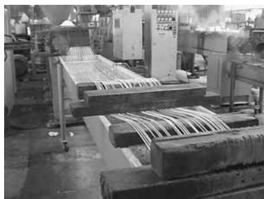
Fig. 24 樹脂の再生ペレット化 (ブラジル)
