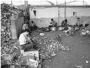
Fig. 18 タガネとハンマーでの手解体 (中国)
