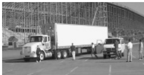
Fig. 2 CE CERTの移動排気ガス実験室トレーラ。トラックが道路上を移動する時にトラクターから出る排気ガスをトレーラ内で測定する
