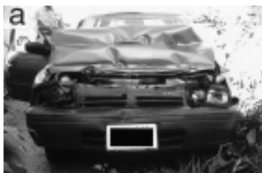
(a) トラックへの追突によるフロントグリルとボンネットの破損
