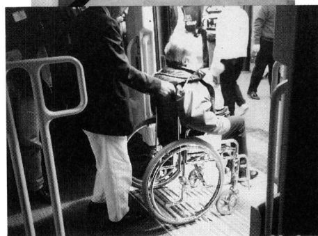
プラットフォームは地上20cm程度、LRTの床高も20cm程度。
