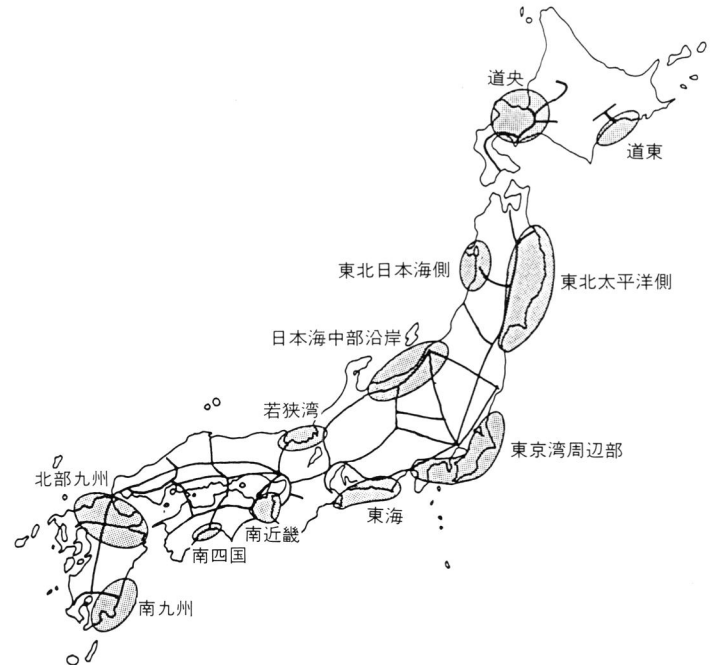
注1) 積載量1,000トン級速度50ノット船舶で1日1便又は2日に1便が前提。 2) 1日1便は2日に1便における採算ベースの貨物量と2000年における想定地域間貨物量(雑貨貨物量の10%又は20%)の比較及びトラック、鉄道との時間差により想定。 3) 従って、船舶、積載量、輻輳海域における夜間運航の可否。燃費等諸条件が変化すれば、様々な運航形態、ネットワークが考えられる。 4) 図中の太線は国幹道計画における整備計画区間までを示している。 出典) 運輸省港湾局編「豊かなウォーターフロントをめざして」
