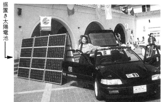
ルーフ、リヤに太陽電池をうめこんだ電気自動車 Fig. 10 カソリン車と同じ高性能を備えたスポーツタイプのソーラー・バッテリーカー
