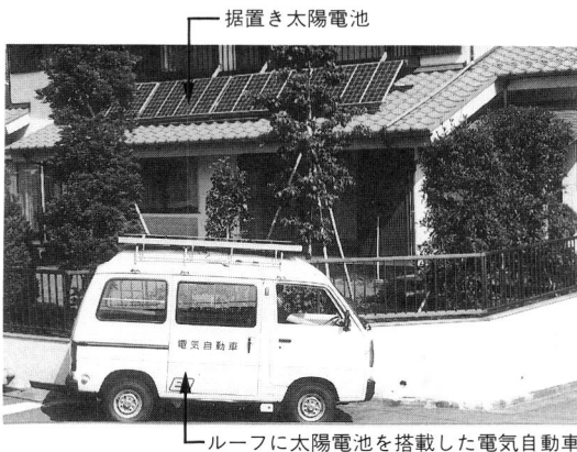
Fig.2 据置き太陽電池と路上テストに使われた太陽電池搭載の電気自動車
