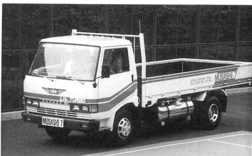
Fig.18 高圧噴射4サイクルエンジン搭載のトラック （4トン積み）
