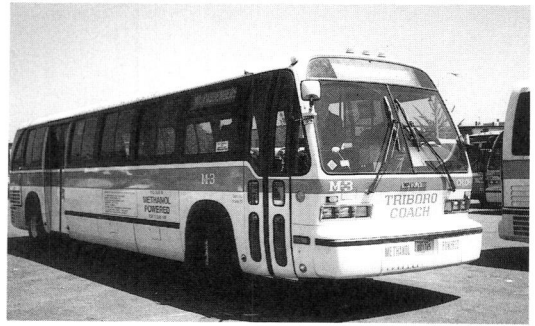
Fig.8 DDCメタノールバス、ニューヨーク州トリボロコーチ、触媒使用
