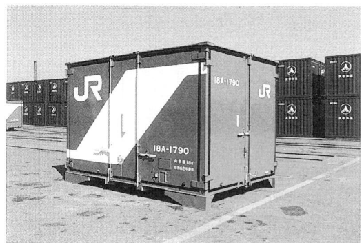
Fig. 6 高さ2.51mのJR規格の12ft標準タイプのドライコンテナ
