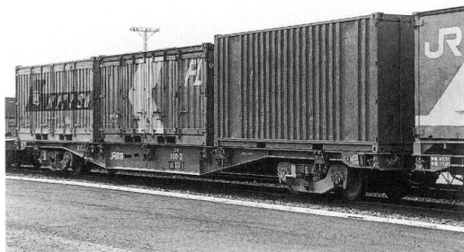
Fig. 7 高さ8ft6inの海上コンテナ (右側) を積んだ新型低床コンテナ貨車
