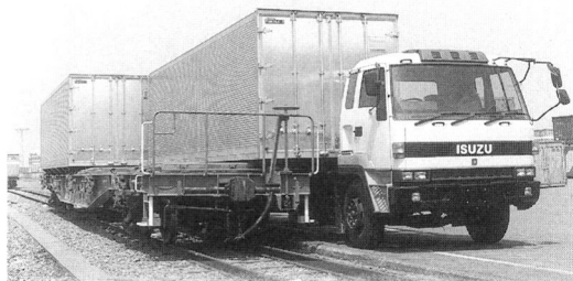
Fig.12 SVS輸送方式のバンボディーの積み替え状況
