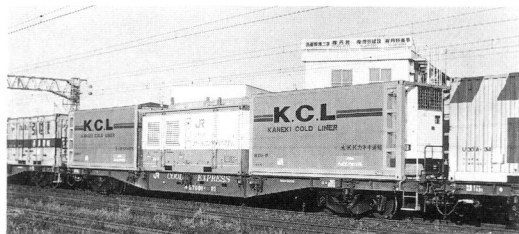
Fig.10 札幌～東京間で営業開始したJRクール・コンテナ輸送（中央は電源コンテナ）
