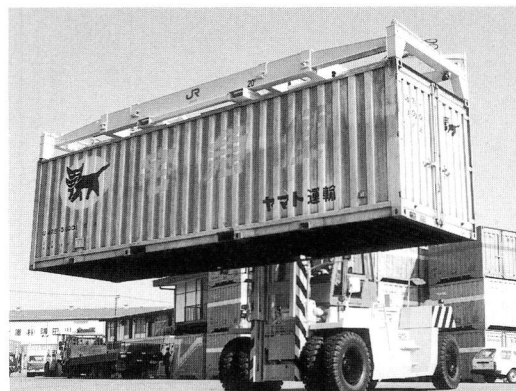
Fig. 9 30ftの大型コンテナを荷役中のトップリフター
