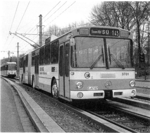
Fig. 11 路面電車とバスの共用軌道 (エッセン、西独) 9) Exclusive guideway for bus and tram-car (Essen, FRG)
