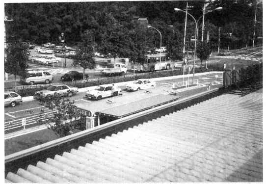
Fig. 6 朝のキス&ライド風景。手前からバスレーン、タクシーレーン、一般街路。タクシーレーンがキス&ライド降車と停車に使われている。まれにバスレーンも利用されている(東急田園都市線あざみ野駅、1987年9月撮影) Another morning "kiss & ride" scene. The bus and taxi lanes in the foreground with a road in the background. The taxi lane is used to pick up and drop off people. The bus lane is also used occasionally. (Azamino Station, Tokyu Den-entoshi Line, September, 1987)
