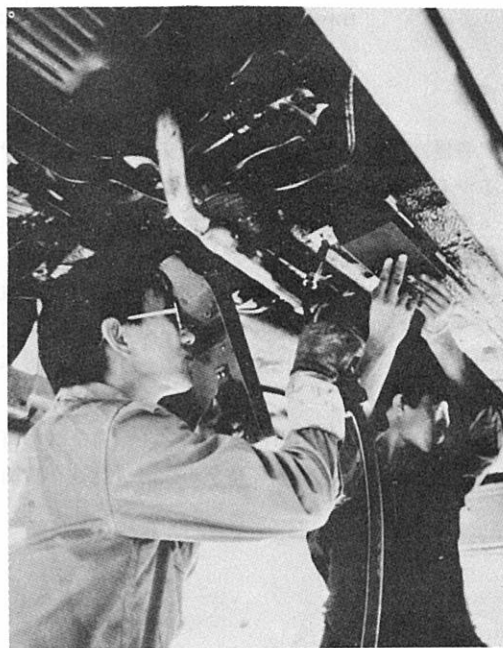
Fig. 2 ENP(電子式ナンバー・プレート)の車体下面への溶接装着 The welding of an Electronic Number Plate to the underside of a car
