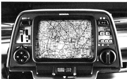
Fig.4 地図シートを挿入した状態での表示部の前面 Front view of the display unit with transparent overlay maps fitted to the screen
