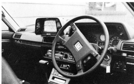
Fig.6 運転席に装着された表示部の外観 Instrument panel equipped with the display unit
