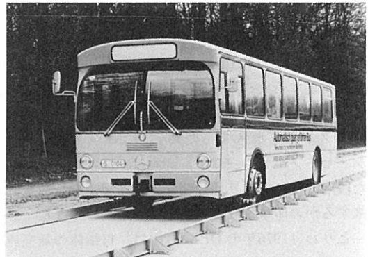
Fig. 4 簡易なガイドウェイを走るデュアルモードバス Dual mode bus running along simple guideway
